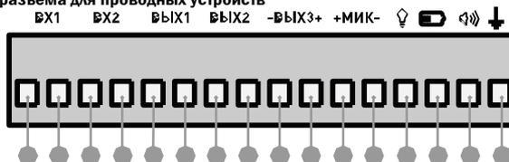
Разъема для проводных устройств предназначен для подключения сирены и проводных датчиков. Подробнее о подключении проводных датчиков - см. Раздел 9 «Подключение дополнительных проводных датчиков».
